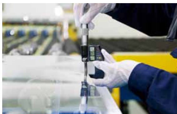
中国建材超薄电子玻璃厚度达0.15毫米
