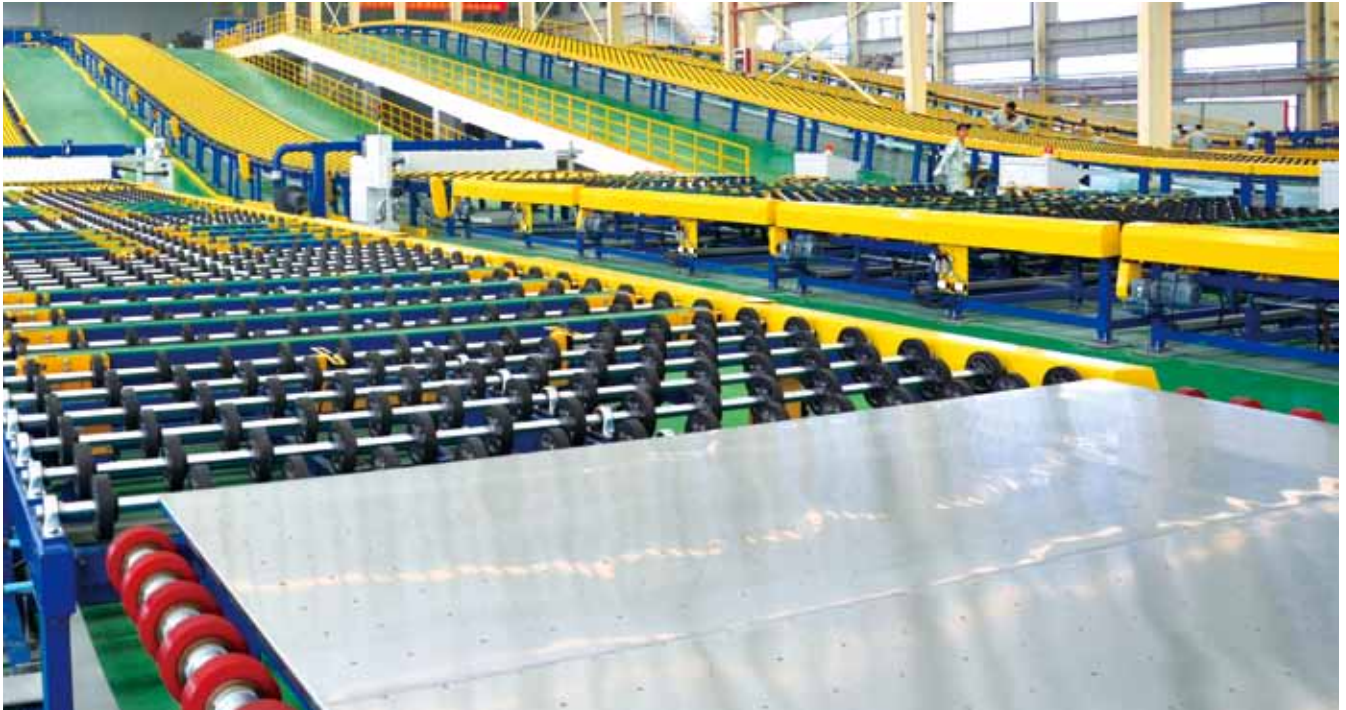
超白高透光伏玻璃生产线
